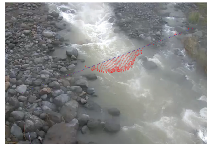
Représentation des vitesses d'écoulement, Rivière des Pluies
